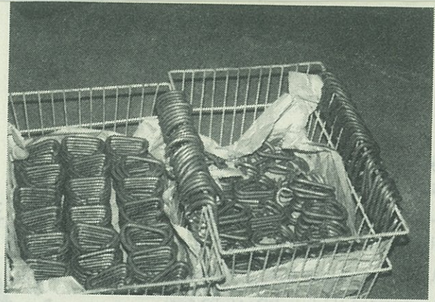
بدنه آماده شده کارابینهای در دست ساخت
