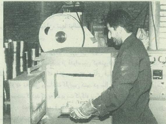
حرارت‌دهی در کوره در دمای بالای ۴۵۰ درجه
