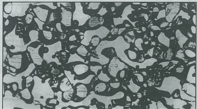
یک مقطع برف تشکیل شده است از دانه‌های یخ قلبه که اغلب به وسیله باریکه اتصال به هم می‌پیوندند و منفذهایی از هوا در میان بلورهای به هم رسیده و پیوسته شده ایجاد می‌شود.
